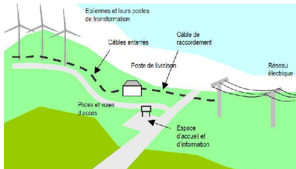
Source : MEDDTL - Schéma descriptif d'un parc éolien terrestre (rapports d'échelle non représentatifs)
